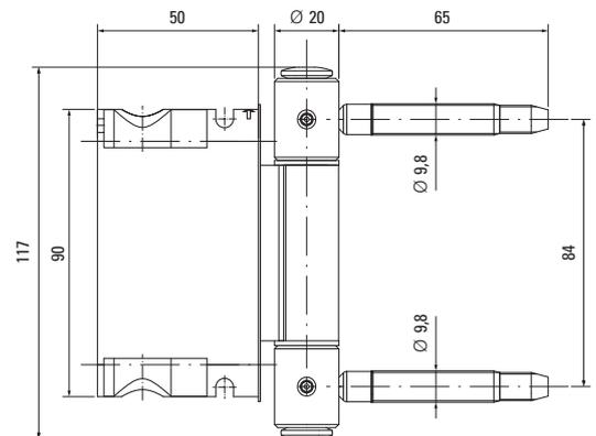
Трехдиаметровые стержни и использование двухдиаметрового наконечника для сверления отверстий обеспечивают простое и надежное крепление петель.
