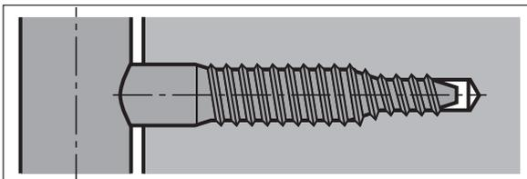
По завершении ввода стержня отверстие идеально подстраивается под стержень, обеспечивая надежность крепления по всей его длине.
