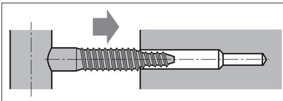
Когда отверстие, просверленное двухдиаметровым наконечником, готово, первая часть стержня без затруднений входит в отверстие и автоматически вставляет петлю.
